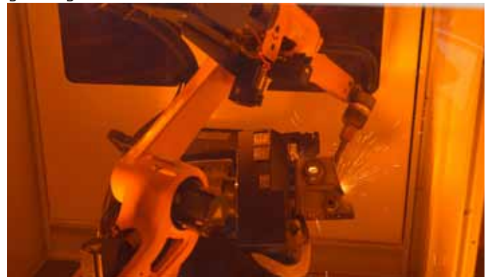
Bild 3: Jede Schweißzelle ist mit einem QIROX QRH-280 sowie einem 2-Stationen-Werkstückpositionierer ausgestattet.
