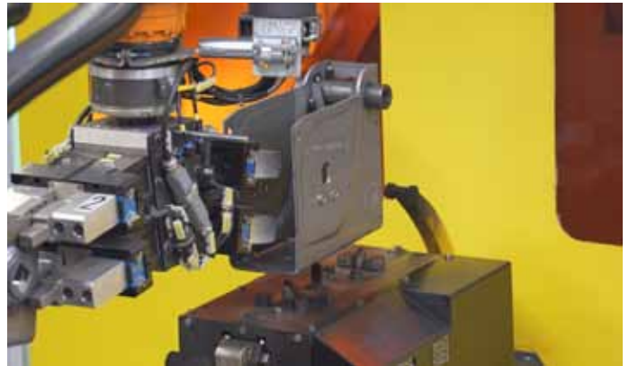
Bild 2: Die Handlingroboter bestücken und entladen die Schweißzellen vollautomatisch.
