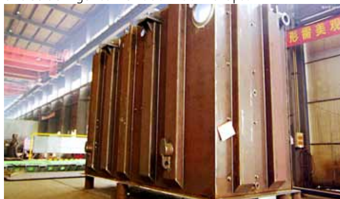
Bild 1: Die neue CLOOS-Anlage bei Shandong Mingrun schweißt Öltanks für Transformatoren.
