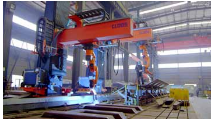
Bild 2: Die Roboteranlage ist fast 40 Meter lang und besteht aus mehreren Stationen.
