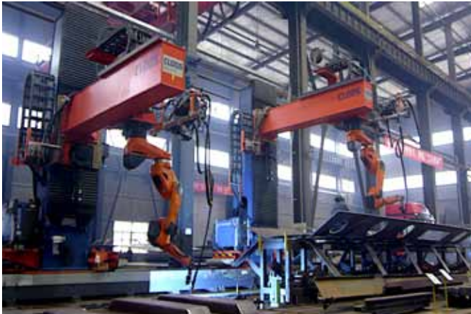
Bild 4: Die beiden Roboter können entweder gemeinsam an einem Bauteil oder getrennt an den verschiedenen Stationen schweißen.
