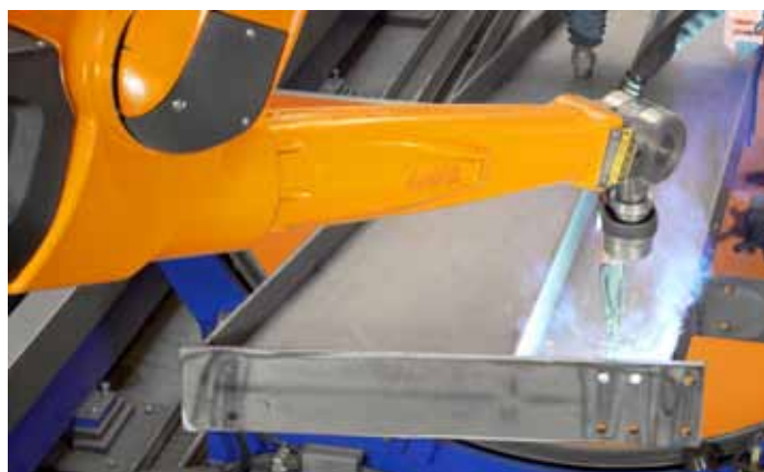
Bild 1: Die QIROX-Roboter schweißen komplexe Stahlbauteile für die Hallenfertigung.
