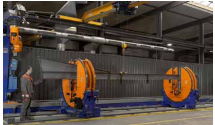
Bild 2: Auf der CLOOS-Anlage können Bauteile mit einer Länge von 7 bis 16 m geschweißt werden.
