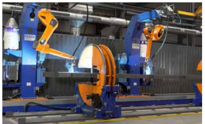
Bild 3: Die in Überkopf-Position montierten Roboter können auf der Bodenfahrbahn flexibel hin und her bewegt werden.
