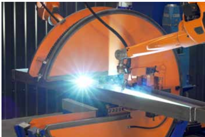
Bild 4: Die Werkstückpositionierer können ein maximales Gesamtgewicht von 2,5 t aufnehmen und sind manuell verschiebbar.
